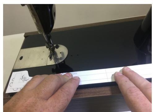
4-) После того, как декаль вырезана, выбираем место для нанесения, и, прицельно (у рисунков в качестве параметров есть осевые линии на обороте, для лучшего позиционирования), наклеиваем ее на поверхность машины, желательно оказывать определенное давление на бумагу, для лучшей фиксации клея      **ВАЖНО:** (после вставки не пытайтесь перемещать или удалять).
